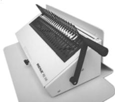
Bindhebel muß ganz am hinteren Anschlag stehen. Binderücken in Haltekamm einlegen, Zähne müssen nach hinten unten zeigen. Binderücken mit Bindhebel ca. 2/3 öffnen. Rändelschraube öffnen, nach rechts bis zum Anschlag schieben und wieder festziehen. Aufziehweite ist so für weitere Bindvorgänge fixiert
