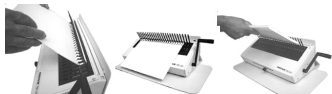
Das perforierte Papier senkrecht in den Binderücken einkämmen und nach vorne ablegen. Bei dickeren Blöcken Vorgang wiederholen. Sind alle Blätter eingekämmt, Bindhebel ganz nach hinten bis zum Anschlag drücken und gebunden Block nach oben herausnehmen. Fertig!
