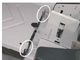
Pro umístění prodloužení na výstupní podavač nasměrujte podle obrázku výstupy na prodloužení do drážek na výstupním podavači. Pro umístění prodloužení není nutná žádná velká síla – prodloužení jsou udržována ve své poloze vlastní vahou.
