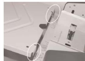
Para instalar la extensión en el transportador de salida, alinee los topes de cierre de la extensión de la bandeja con las ranuras situadas en el transportador de salida. No es necesario ejercer fuerza para instalar la extensión, pues la fuerza de gravedad llevará la extensión a su posición respectiva.
